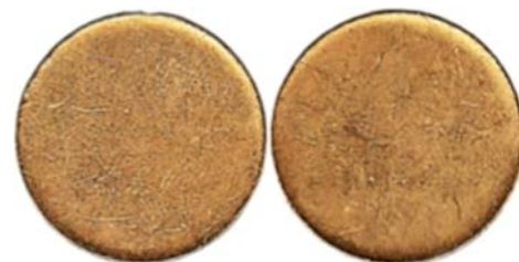
Abb. 4: Ronde für ein 50-Cent-Stück. Die Materialzusammensetzung und das Gewicht entsprechen einem Original. In China werden auch die Ronden für die illegale Prägung von Euro und Cent hergestellt. Ø: 23,86 mm, Gewicht: 5,0 g, Legierung: Cu 93,87%, Zn 5,01%, Sn 1,05%, Fe 0,034% (CuZn 5 Tomb. 4,0)
