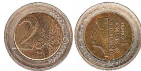
Abb. 2: Gefälschtes, niederländisches 2-Euro-Stück, vermutlich aus chinesischer Produktion. Ø: 25,94 mm, Gewicht: 5,5 g, Legierung (Pille): Cu 42,51%, Fe 44,71%, Zn 12,19%, Co 0,270%, Ni 0,164%, Mn 1,33%, Sn 0,017% Legierung (Ring): Cu 52,07%, Zn 30,23%, Ni 10,37%, Fe 5,69%, Pb 1,24%, Sn 0,235%, Co 0,079% Die Münze ist ohne Randschrift und zu stark magnetisch.
