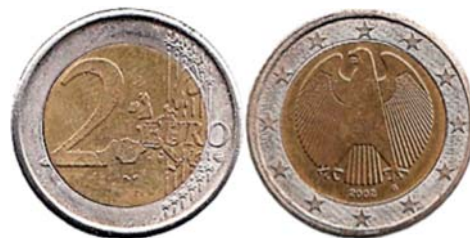
Abb. 3: Gefälschtes, deutsches 2-Euro-Stück, vermutlich aus chinesischer Produktion. Ø: 25,80 mm, Gewicht: 5,3 g, Legierung (Pille): Cu 69,93%, Zn 30,03% (CuZn 30 MS 7 0 0) Legierung (Ring): Cu 65,38%, Zn 29,98%, Ni 4,48%, Fe 0,091% Diese Münze ist nicht magnetisch.
