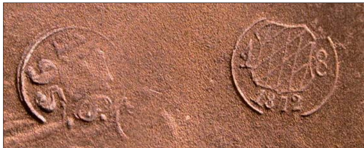
Abb. 2: Die Erst-Eichpunze, bayer. Raute zw. 1 und 8 für Amberg, und 1872 sowie die Punze der Nacheichung von 1895
