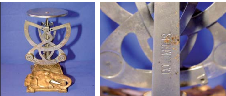
Abb. 3 (li.): Ein Doppelschwinger mit Elefantkopf als Fuß; Abb. 4 (re.): Die Firmenmarke COLUMBUS
