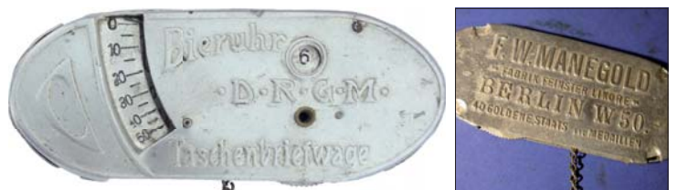
Abb. 10 (li.): Die Taschenbriefwaage inkl. Skala und Bieruhr mit Bieranzeige, z.B. 6 getrunkene Biere; Abb. 11 (re.): Die Fa. Manegold, Reklame
