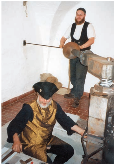
Der Einleger am großen Balancier in Stolberg. Im Hintergrund wartet ein Gehilfe, um die tonnenschwere Querstange herumschleudern
