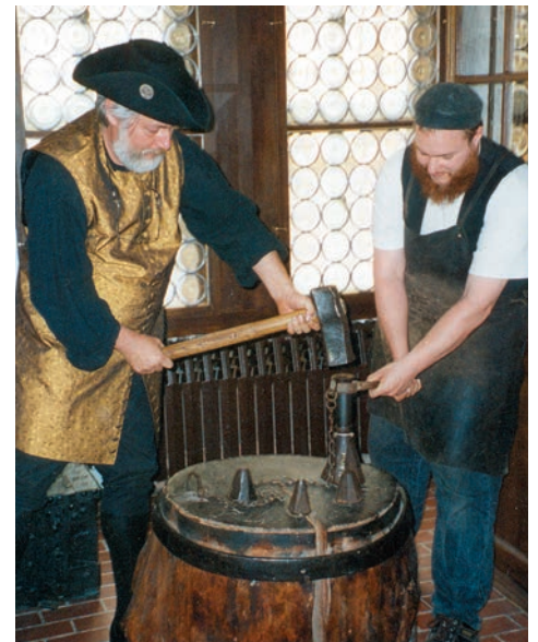
Hammerschlag, die älteste Münzprägemethode bis vor 200 Jahren
