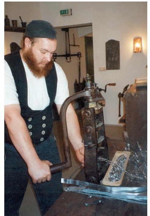
Am Durchstoß wird das Münzplättchen aus dem Zain gewonnen
