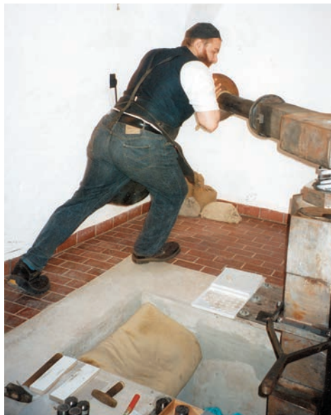
Die Querstange am Balancier muß kräftig angeschoben werden
