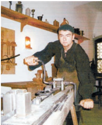
Das Strecken der Zaine an der Streckbank
